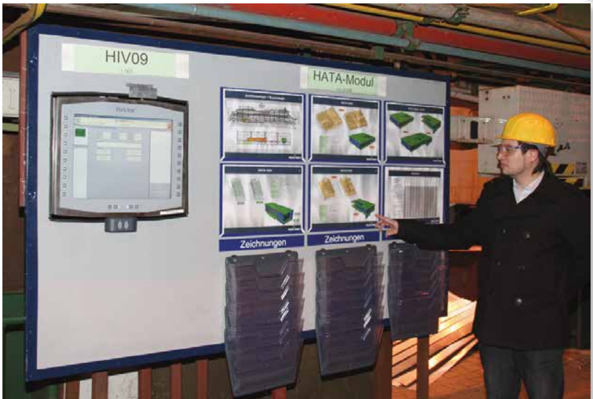
Schnittstelle zwischen Planern, Logistikspezialisten und Monteuren – hier im Schiffsbau: Visualisierungstafel mit integriertem Touchscreen.
