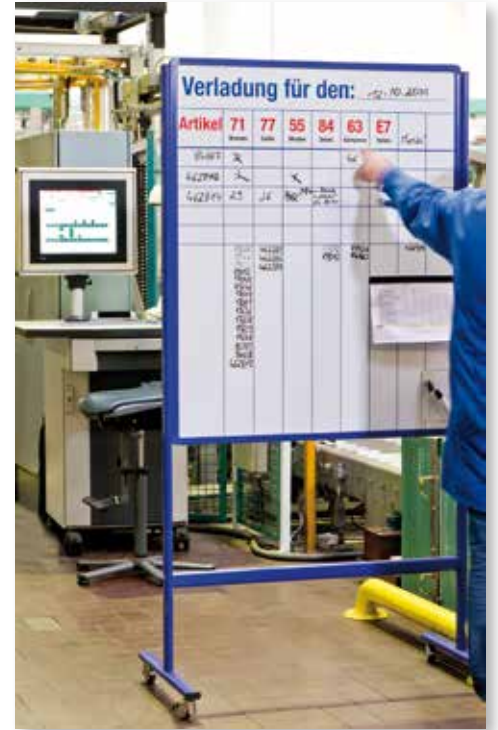
Unterstützt die Koordinierungsarbeit vor Ort: beschrift- und abwischbare Shopfloor-Tafel.
